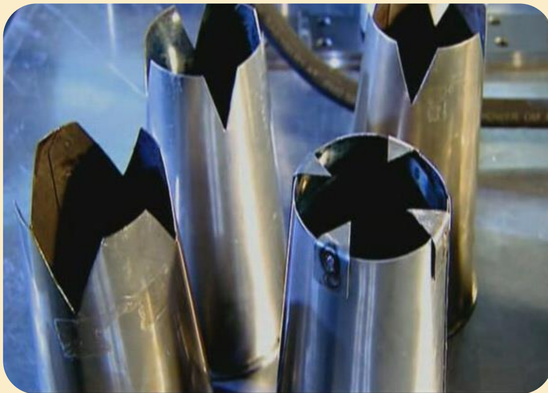
انواع نازل موتور جت مورد آزمایش توسط نیروی هوایی انگلستان جهت نصب در جنگنده تایفون
