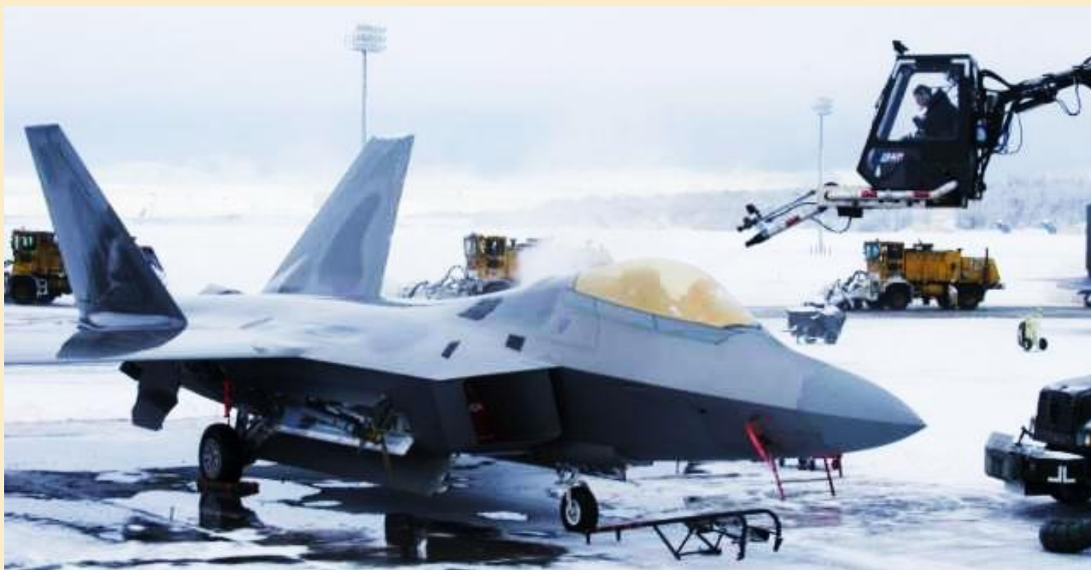
اف-۲۲ رپتور در آلاسکا، یخ زدایی بدنه با دستگاه و مواد مخصوص
