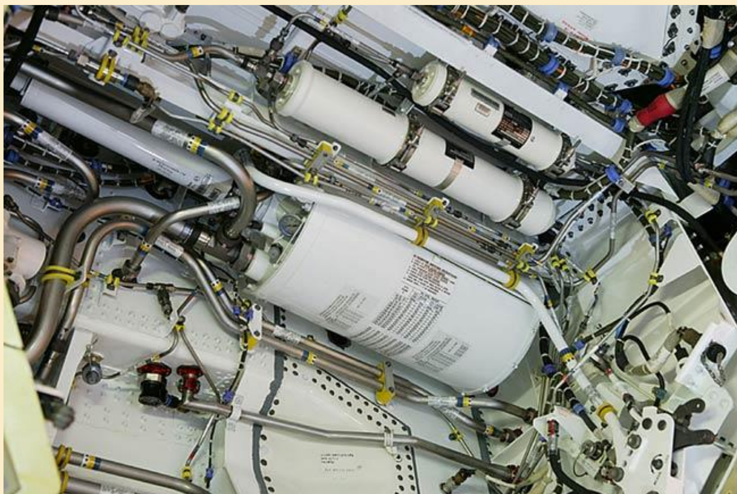
سیستم خنک کننده سنسورهای تصویر ساز در وسط عکس در داخل بدنه اف-۲۲ رپتور
